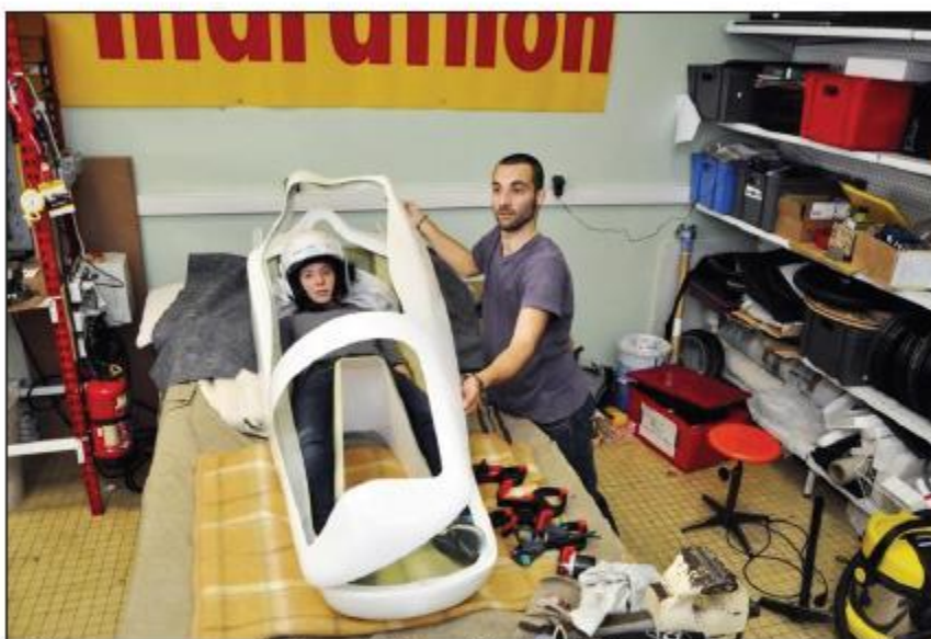
■ Cette coque, encore en polyester sera bien la prochaine Vir'Volt placée entre les mains de sa pilote.
